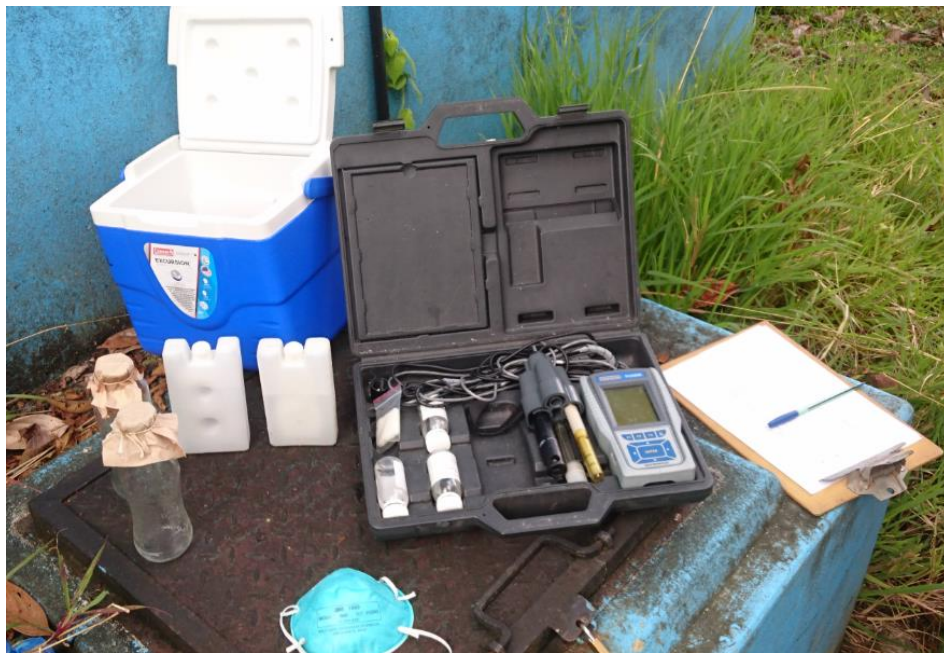
Foto A-6: Equipo multiparametro (Medidor PCD 650) para monitoreo de parámetros de campo.
