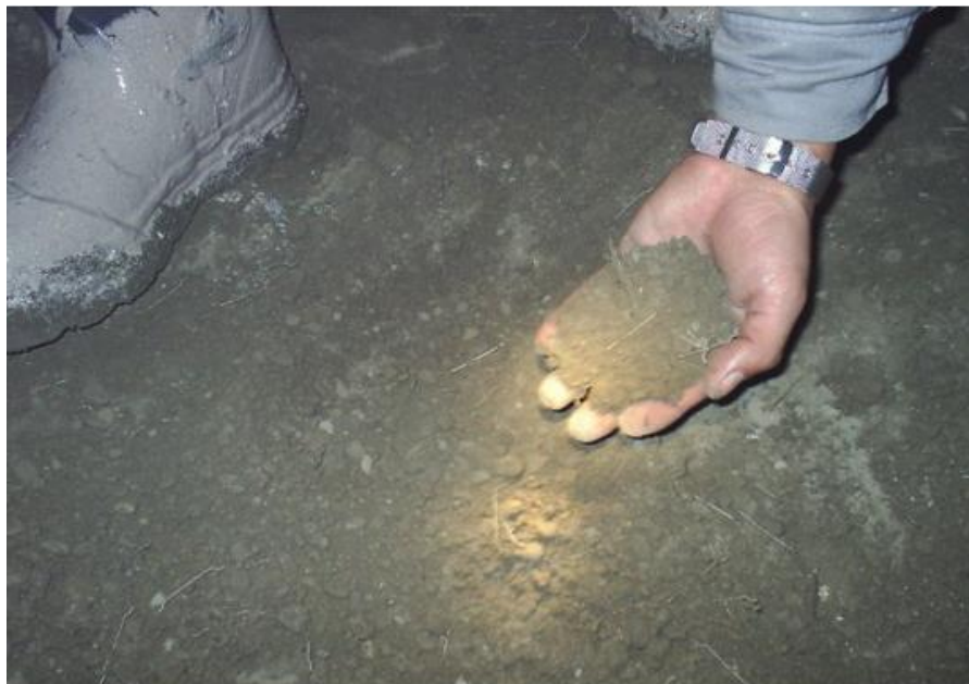
Figura 27: Prueba de la calidad de áridos y de la mezcla vía seca.
