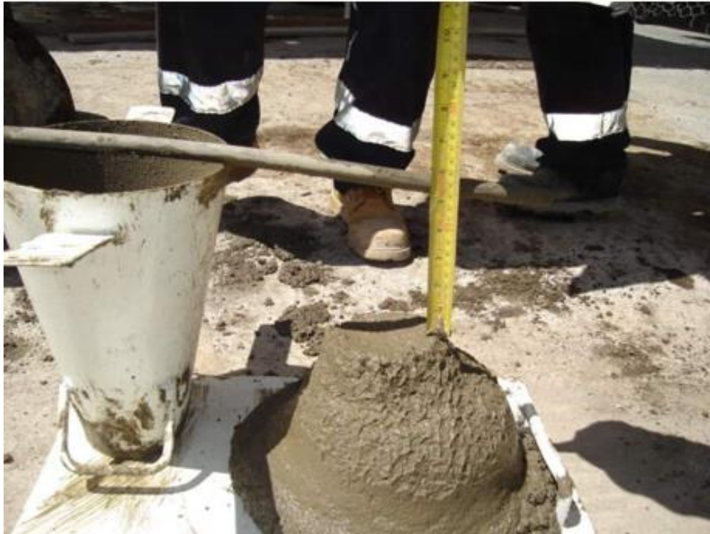
Figura 33: Medición de Slump de mezcla vía Húmeda.
