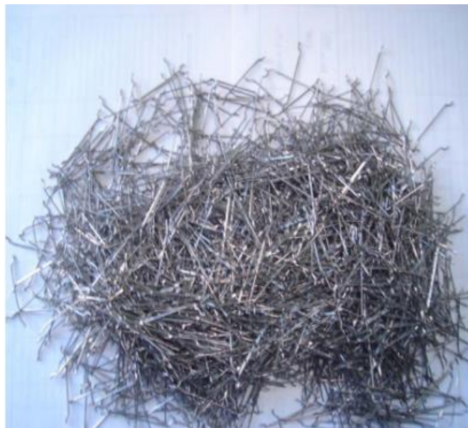
Figura 29: Fibra Metálica suelta 45/35, para shotcrete Vía Seca.
