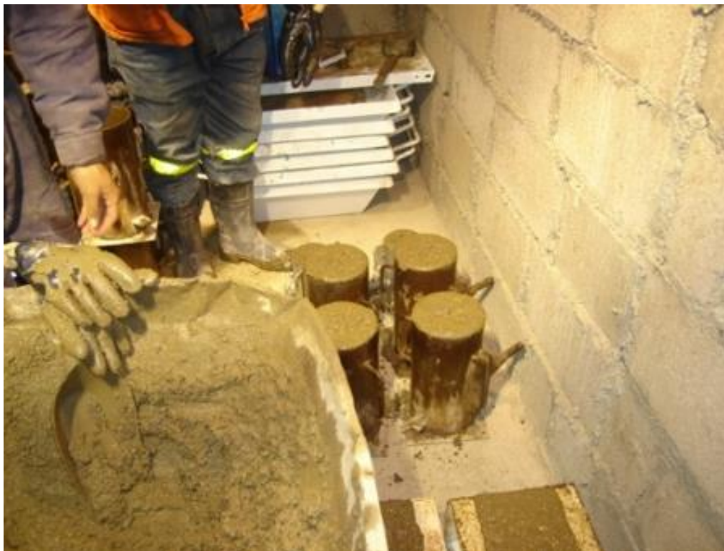
Figura 38: Preparación de moldes cilíndricos para ensayos de resistencia.
