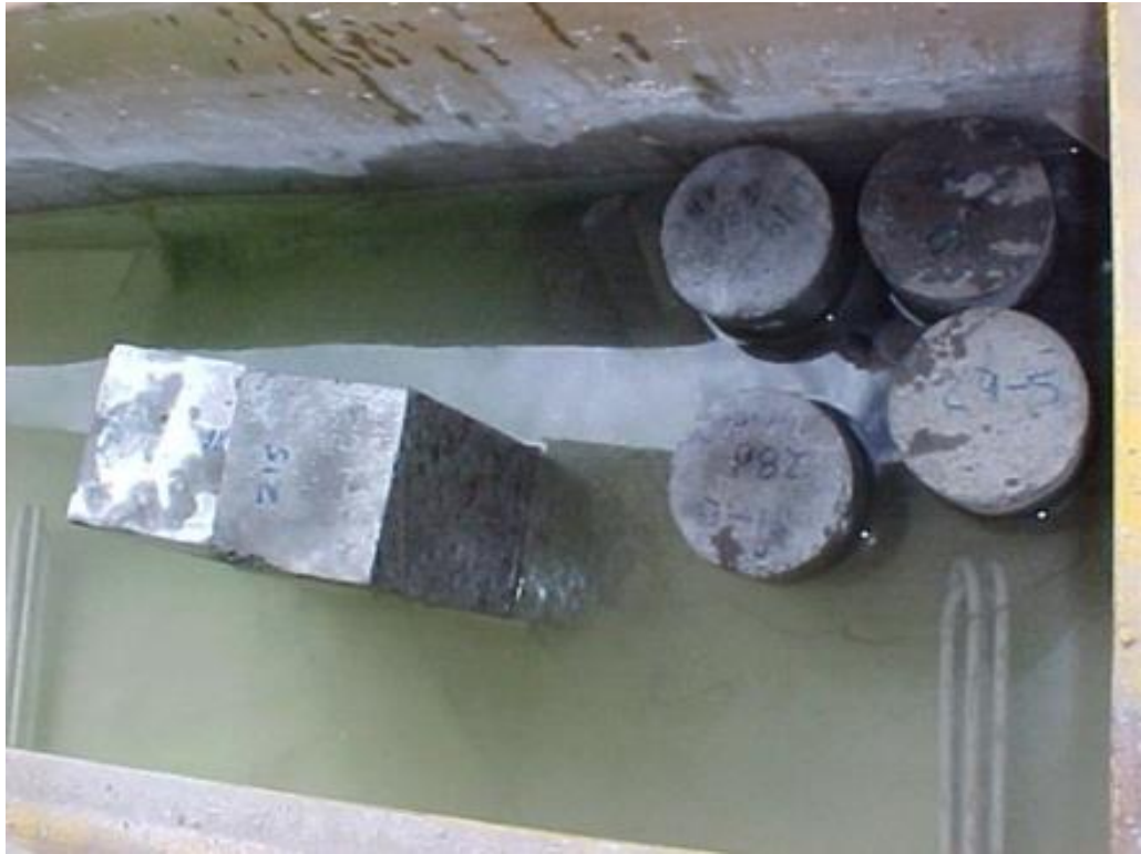
Figura 39: Curado de testigos y moldes cilíndricos de shotcrete.
