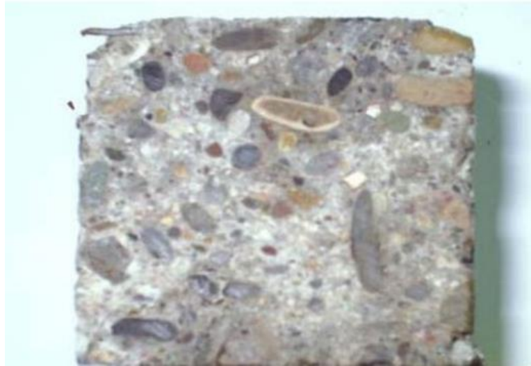
Figura 23: Distribución de áridos en el Shotcrete.
