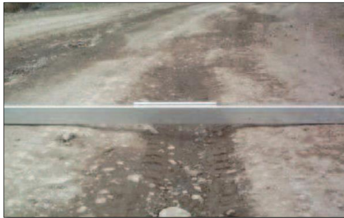
Imagen 6. Gravedad 2: Profundidad entre 5 cm y 10 cm Fuente: MTC
