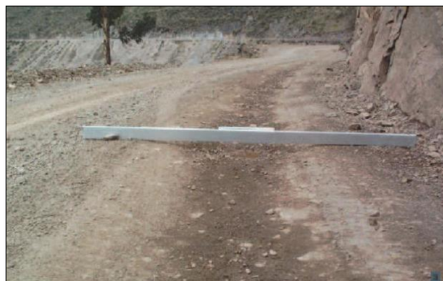
Imagen 4. Huellas/hundimientos \geq 10 cm Fuente: MTC.
