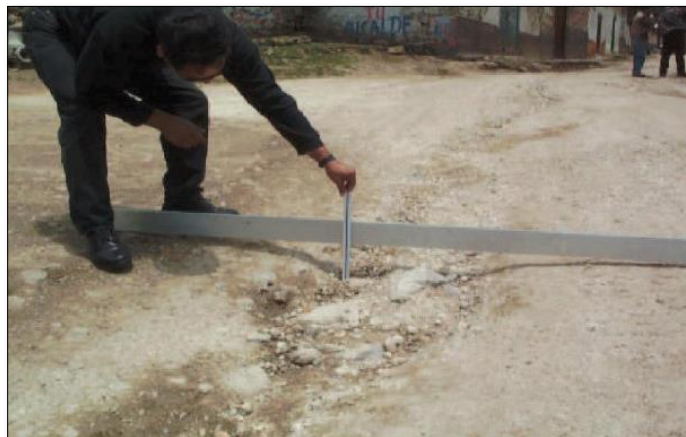
Imagen 7. Gravedad 3: Profundidad \geq 10 cm Fuente: MTC
