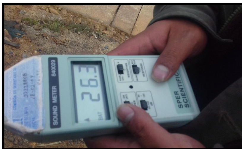
IMAGEN 03: Medida de niveles de ruido.
