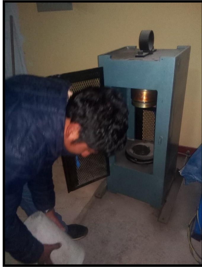
Foto N° 07: Ensayo de la resistencia a la compresión
