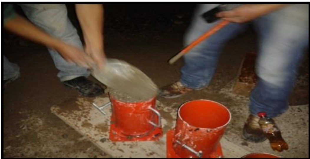
Foto N° 06: Preparación de las muestras para en ensayo de la resistencia a la compresión
