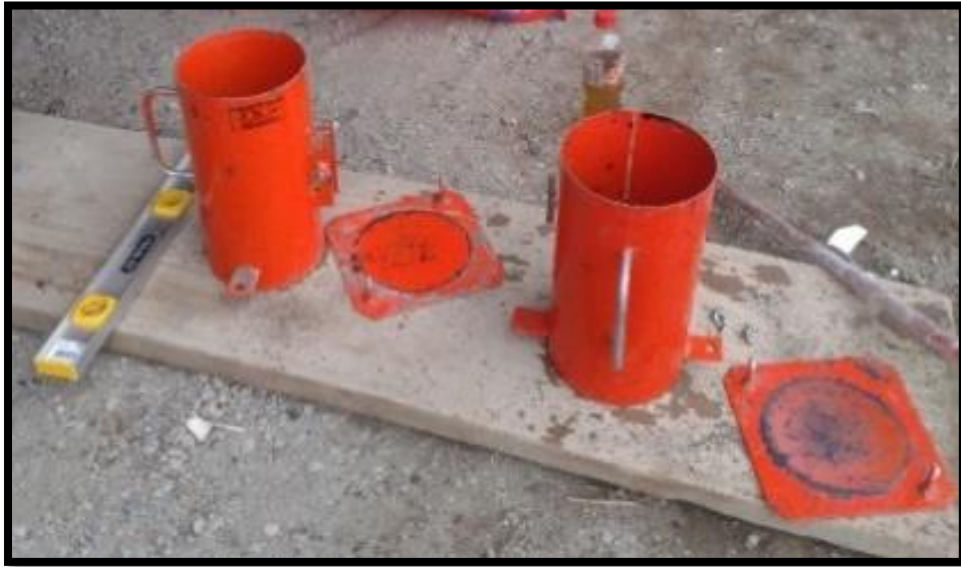
Foto N° 03: Probetas estándar (diámetro de 15cm y altura de 30cm)
