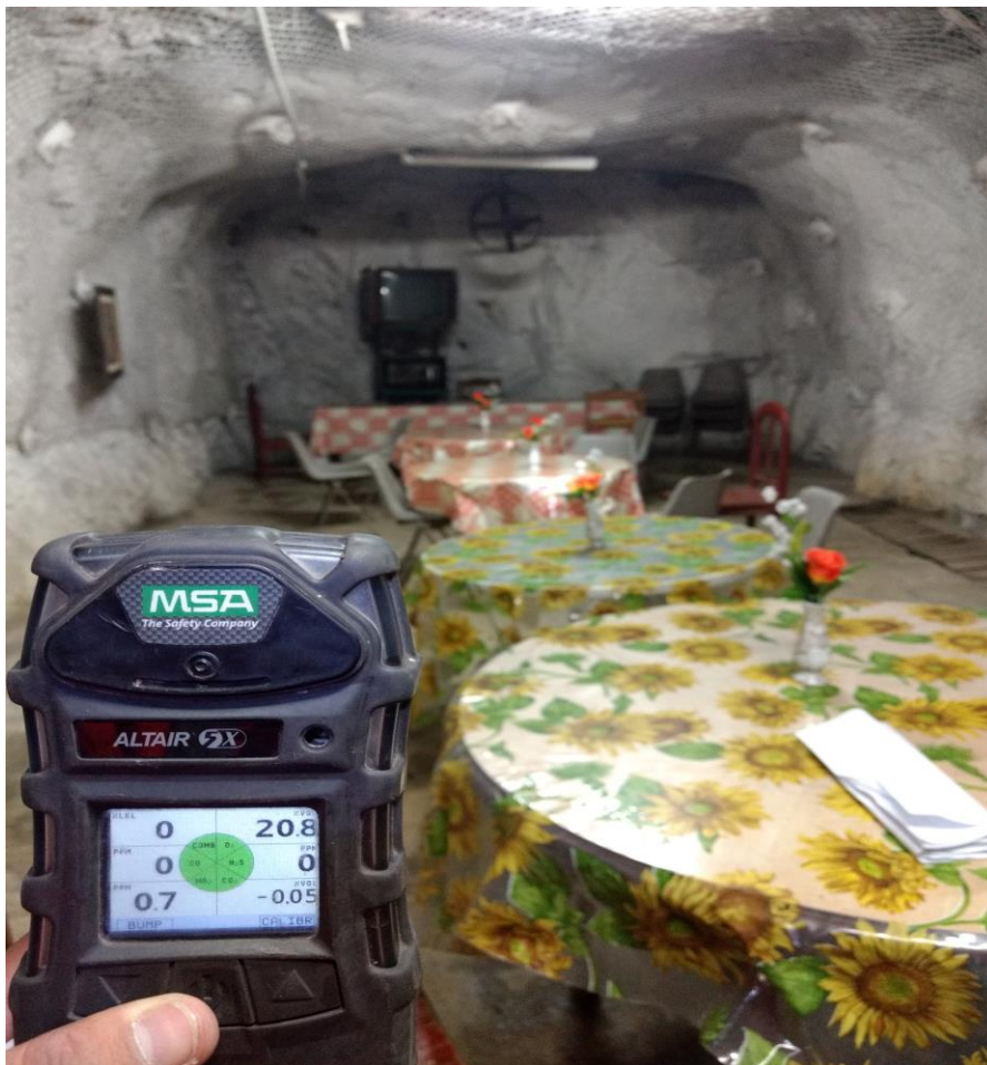
Imagen N°01; evaluación de concentración de gases
