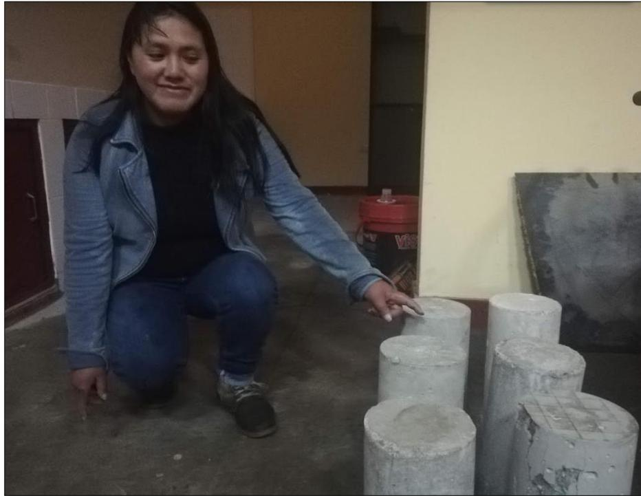
PROBETAS ELABORADAS, LISTA PARA EL ENSAYO A LA COMPRESION
