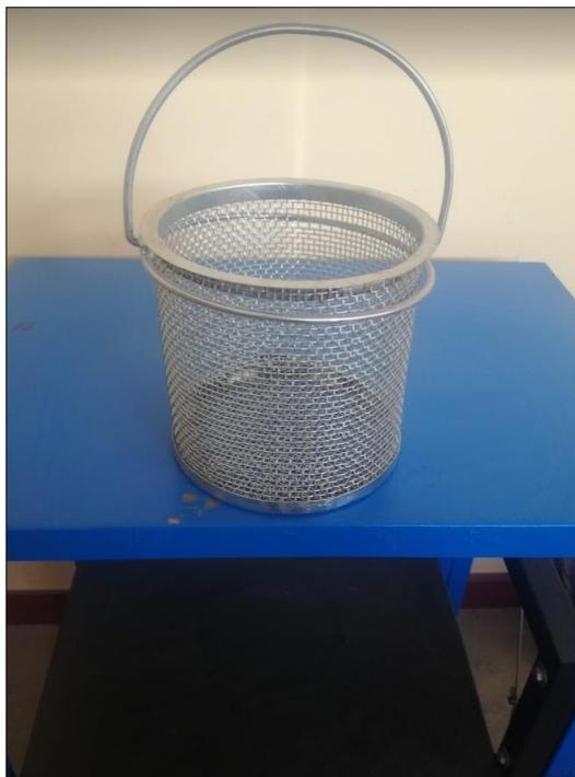
**Imagen 9.** Equipo para peso específico
