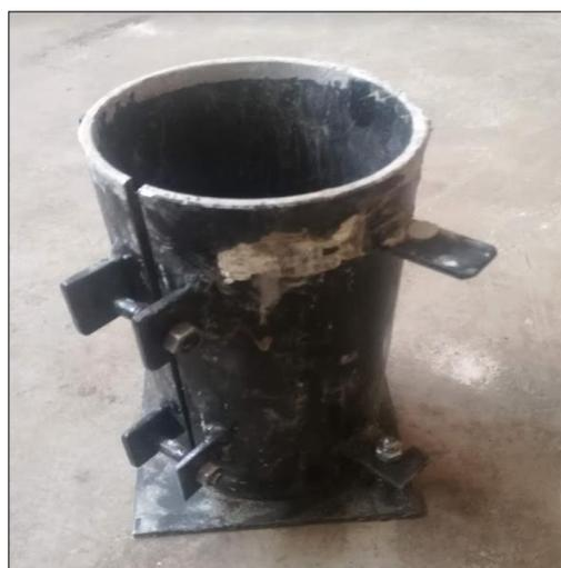
**Imagen 7.** Molde cilíndrico
