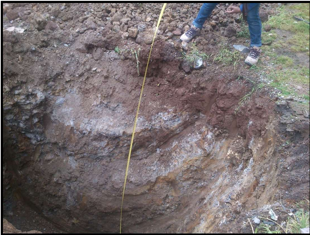
Foto 12. Identificando y midiendo los estratos encontrados.
