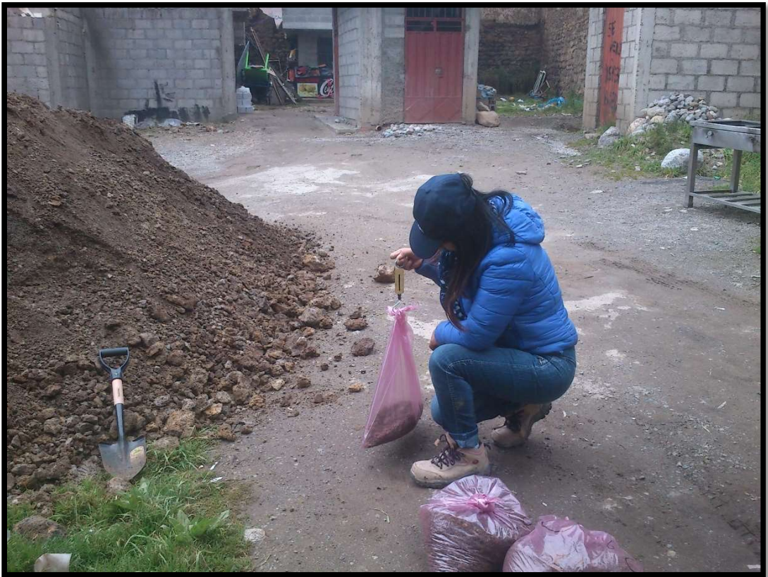
Foto 22. Toma de muestra alterada del suelo.
