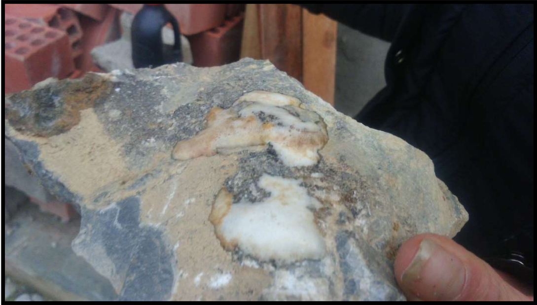
Foto 21. Reacción a ácido, identificando ser roca caliza.
