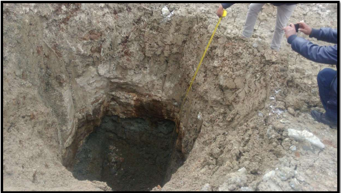
Foto 10. Medición de la profundidad de la calicata y los estratos encontrados.
