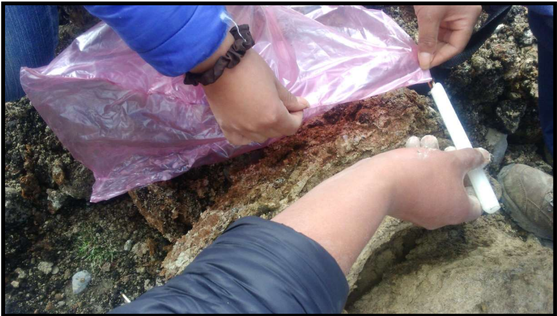
Foto 24. Sellando muestra de 2 kilos para evitar pérdida de humedad.
