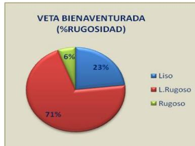
El grado de rugosidad en Bienaventurada es alto siendo la veta principal de la mina, nos muestra un resultado positivo en la estabilidad de las rocas.
