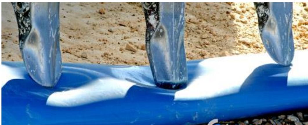
Figura 20. PVC –O 500, Comportamiento elástico de la tubería
