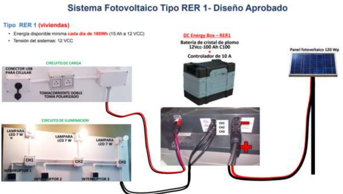
Figura N° 04: Esquema de sistema fotovoltaico domiciliario
